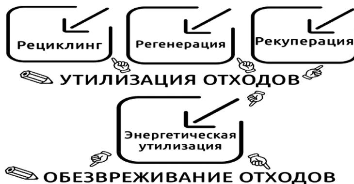
Рисунок 1. Основные элементы обработки отходов производства и потребления
